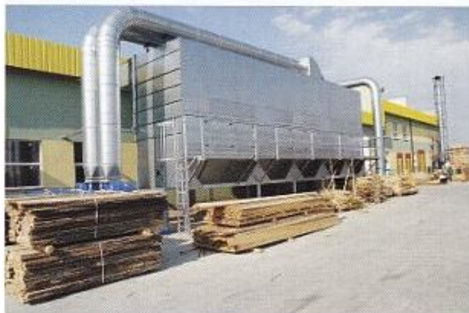
Filtry wchłaniają trociny i zapyłone powietrze z hali.
